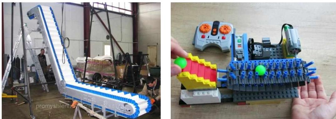
**Транспортер, элеватор** – транспортная машина непрерывного действия, перемещающая грузы в горизонтальном направлении или вверх под углом к горизонту по транспортерной ленте или в транспортных сосудах (ковшах, люльках), прикреплённых к тяговому органу.
