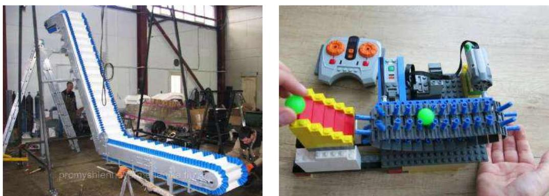
**Транспортер, элеватор** – транспортная машина непрерывного действия, перемещающая грузы в горизонтальном направлении или вверх под углом к горизонту по транспортной ленте или в транспортных сосудах (ковшах, люльках), прикрепленных к тяговому органу.
