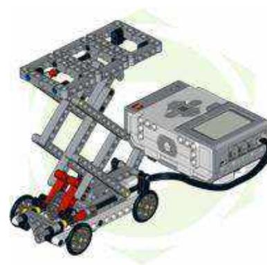
**Ножничный подъёмник** – это подъёмник с системой рычагов и гидравлических цилиндров, на которую опирается металлическая платформа, способная перемещаться в вертикальной плоскости.
