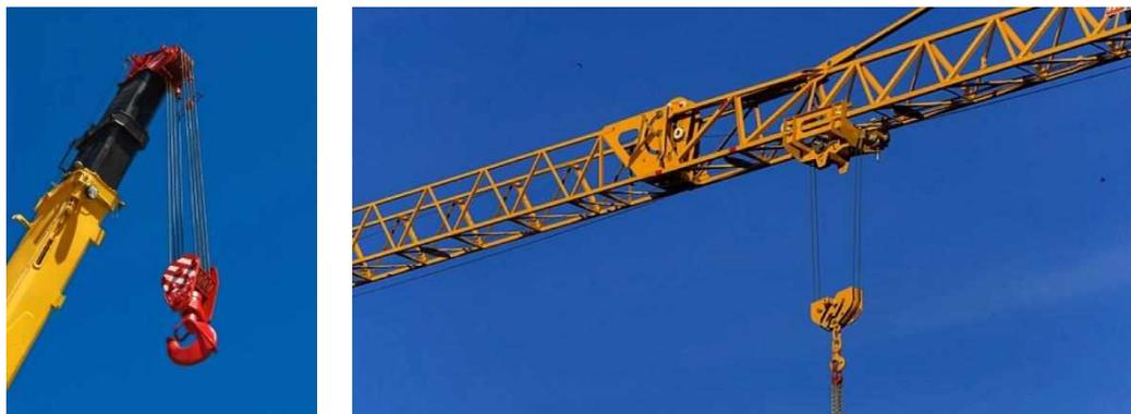
**Полиспаст** – натягиваемое верёвками или канатами грузоподъемное устройство, состоящее из собранных в подвижную и неподвижную обоймы блоков, последовательно огибаемых канатом или цепью, и предназначенное для выигрыша в силе (силовой полиспаст) или в скорости (скоростной полиспаст)
